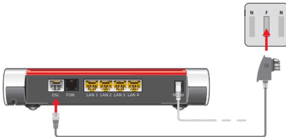
1. Stecke das lange, graue Ende des DSL-/Telefonkabels in die „DSL“-Buchse der FRITZ!Box.
